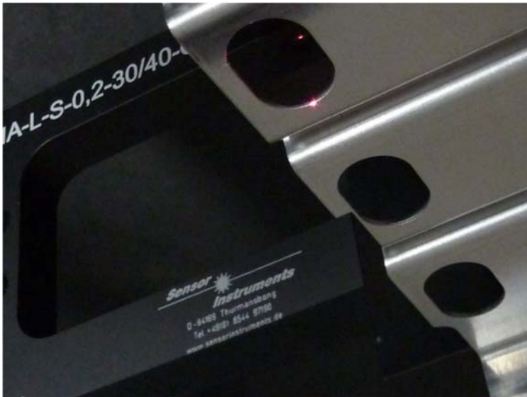
Точное позиционирование штампованной детали благодаря оптическому датчику FIA-L-RL
